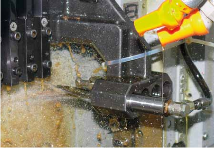
Bild 3: Am Werkzeug muss der KSS stimmen, um reproduzierbar gute Ergebnisse zu erzielen Foto: Claudia Ollenhauer
