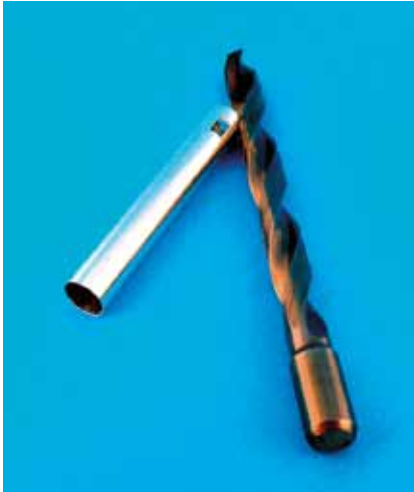
Bild 6: Hülse für Kugelschreiber mit dazugehörigem Bohrer mit Kanälen für KSS Foto: Claudia Ollenhauer
