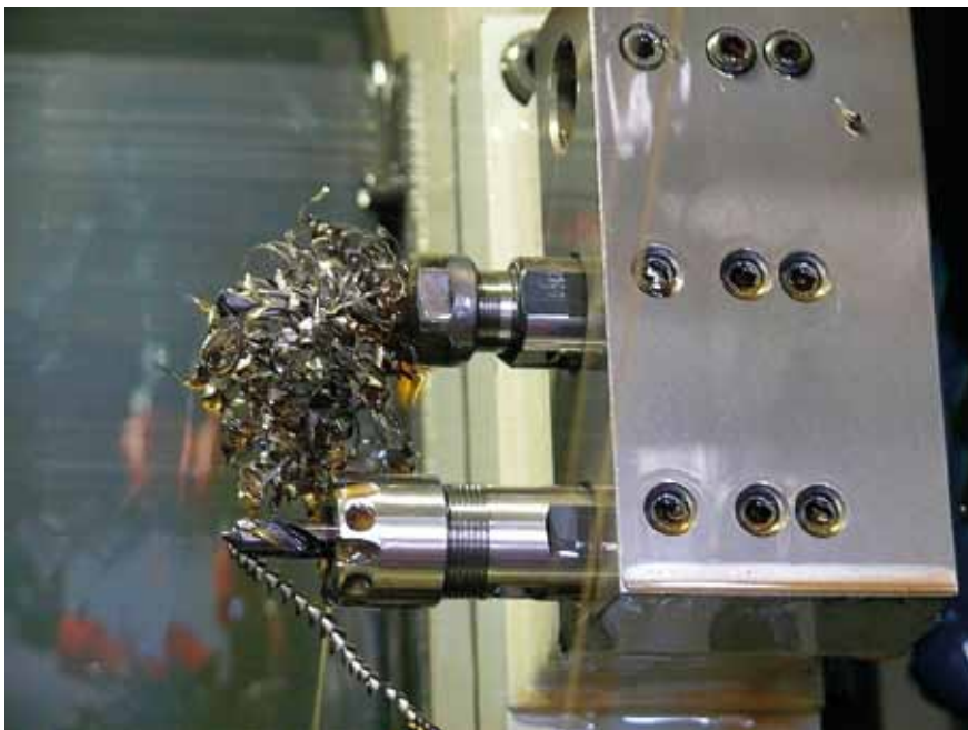
Bild 3: Solche Späne sorgen, wenn sie am Bohrer bleiben, für einen Produktionsstopp
