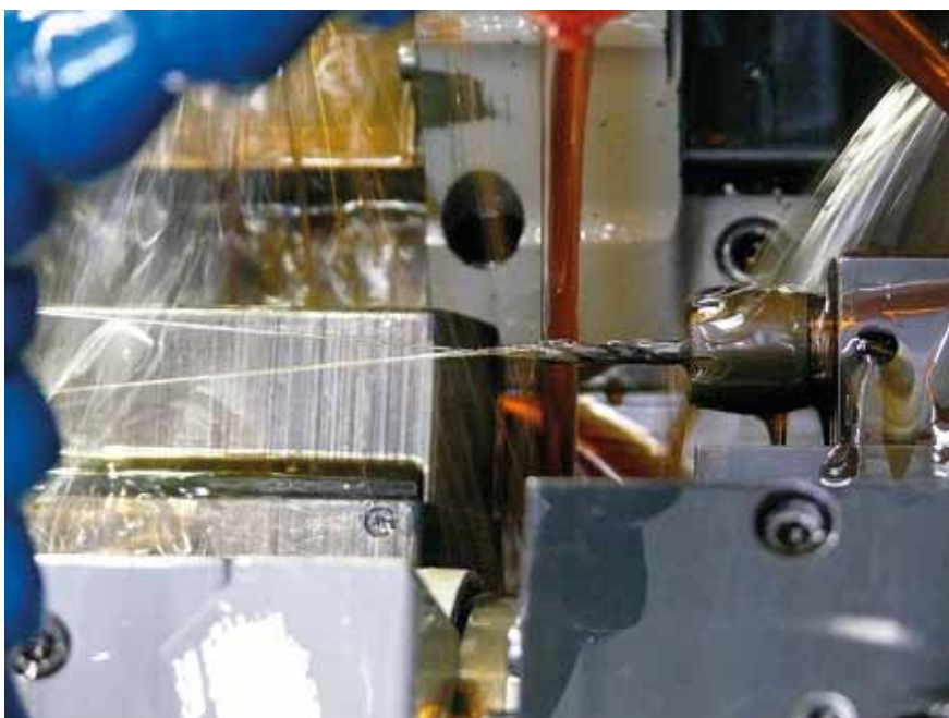
Bild 4: Mit bis zu 150 bar spritzt KSS aus dem Bohrer
