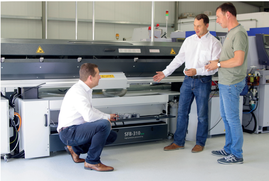
Bild 4: Ordnung für sichere Prozesse: Zur Drehmaschine und zum Stangenlader gehörendes Zubehör wird in den Staufächern der integrierten Hochdruck-Anlage aufbewahrt (Martin Hissler, Michael Büchele, Bernd Braun, v.l.n.r)
