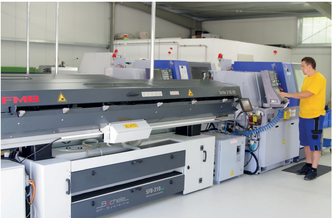
Bild 3: Durch Integration kompakt und sauber: Stangenlader turbo 3-36 HD von FMB mit Hochdruck-Anlage SFB-3610 eco von SF-Systeme Büchele
